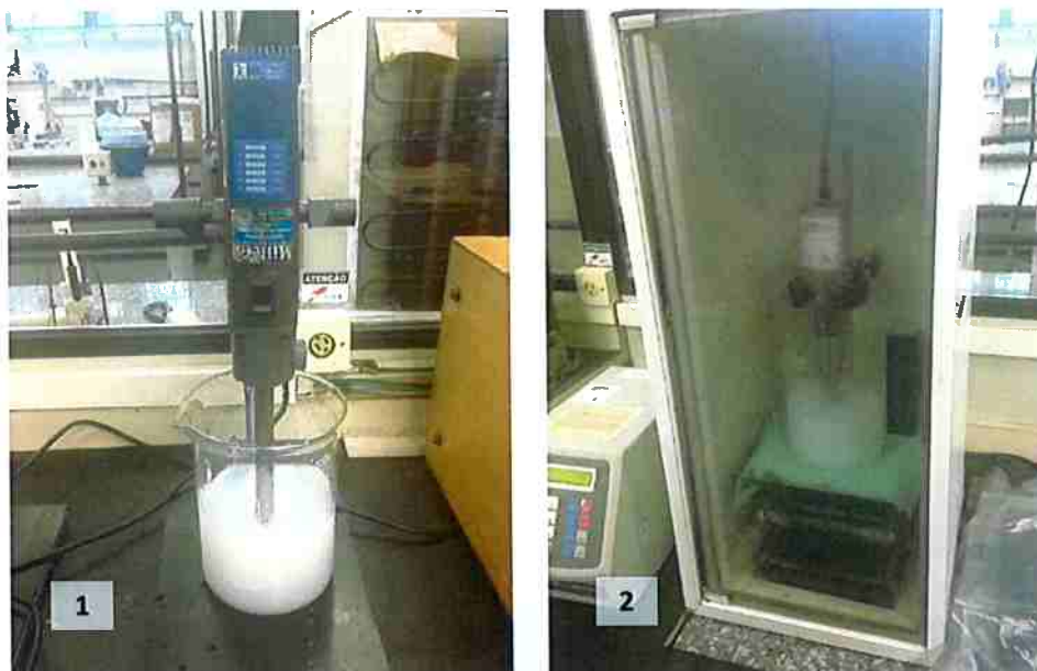
Figura 10: Etapas da homogeneização 1) Misturador mecânico e 2) Ponteira ultrassônica
