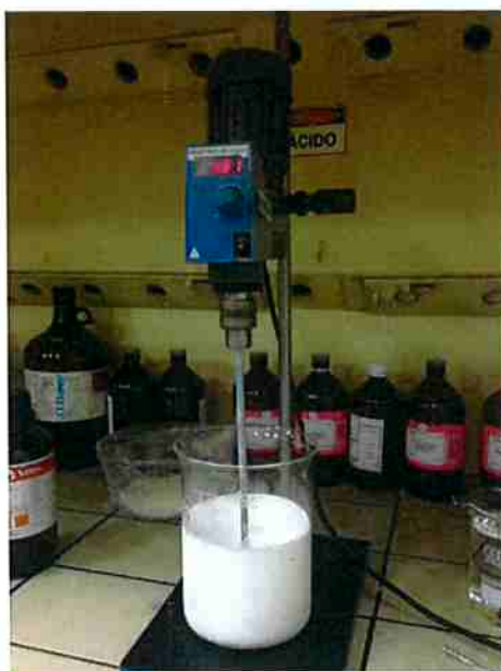
Figura 12: Misturador mecânico utilizado na mistura de látex e solução de nanocelulose
