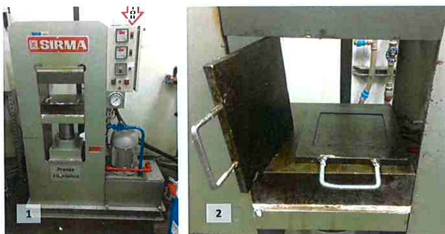
Figura 21: 1) Prensa hidráulica com aquecimento 2) Molde padrão de 2mm de altura
