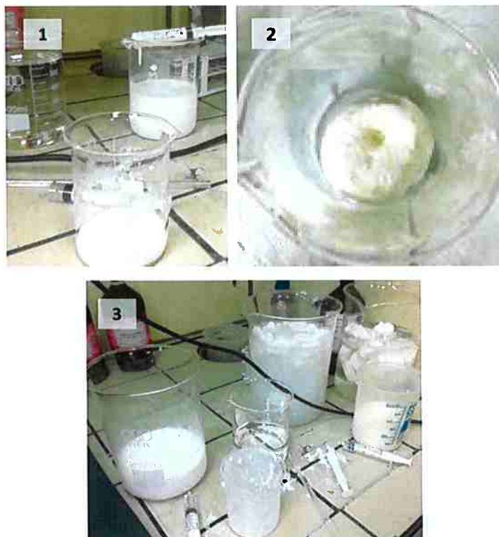
Figura 13: Etapa de coagulação: 1) Látex e solução de ácido acético e béquer para coagulação 2) Borracha coagulada 3) Materiais utilizados
