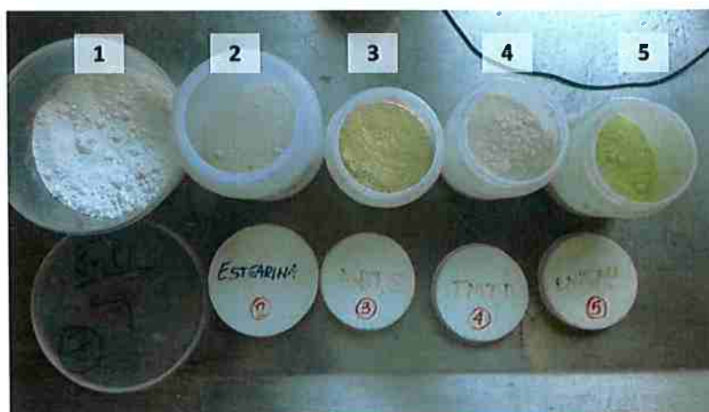
Figura 17: Aditivos das borrachas: 1) Óxido de zinco 2) Ácido esteárico 3) MBTS 4) TMTD 5) Enxofre
