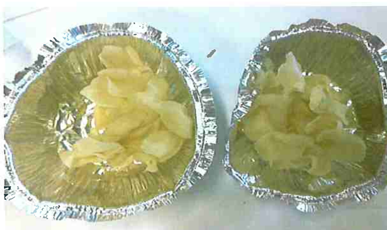
Figura 15: Borracha natural pura (esquerda) e borracha com nanocelulose (direita) após a etapa de secagem
