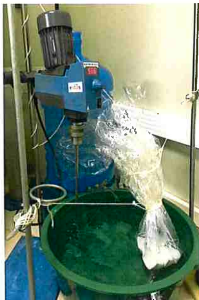
Figura 9: Aparato para etapa de diálise em que água deionizada corrente permanece em contato com a solução de nanocristais de celulose
