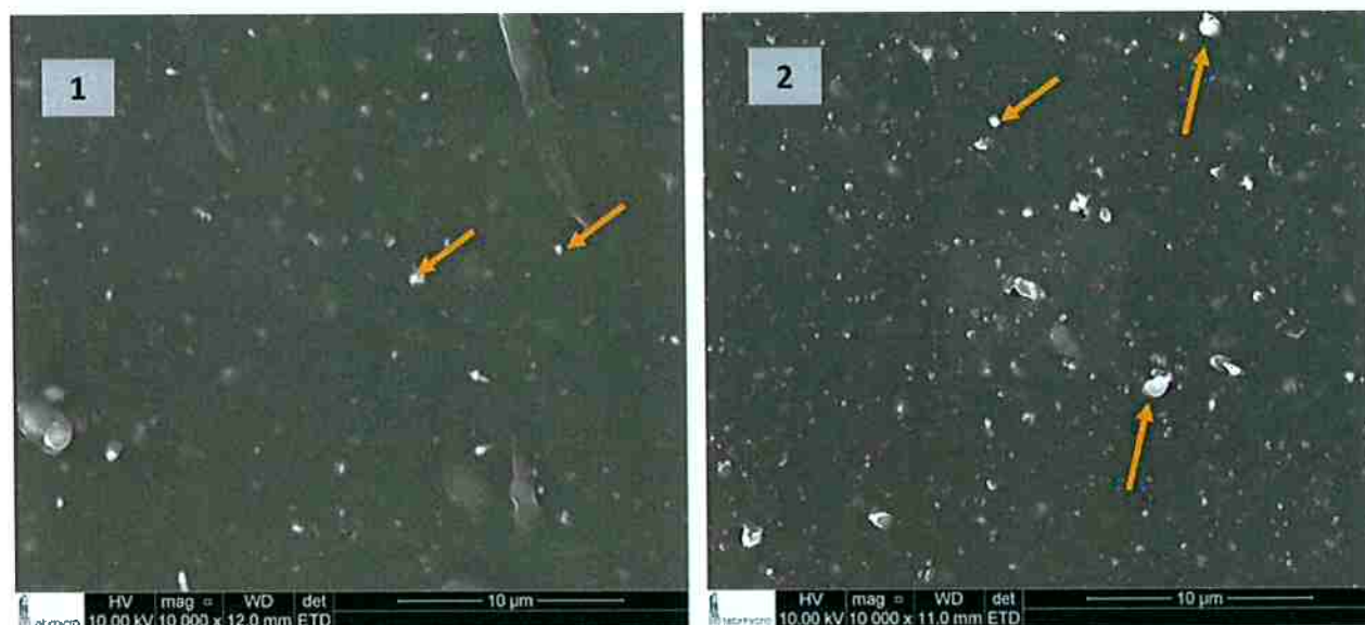
Figura 27: Micrografias obtida por MEV em aumento de 10.000x para as amostras 1) BN 2) BN7,5 NC
